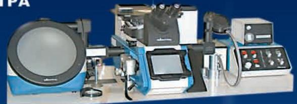
Микроскоп металлографический MEF-3
