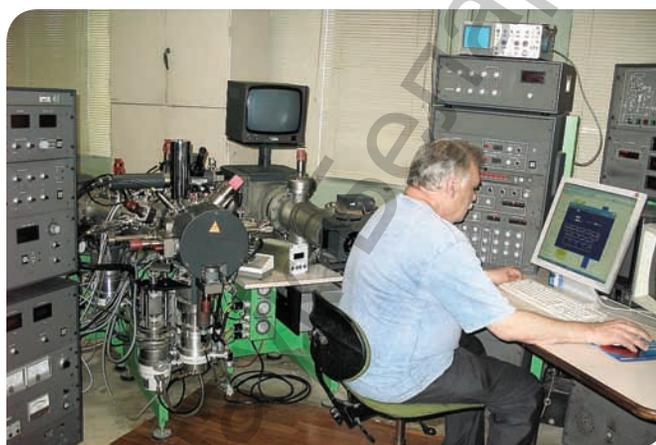
Масс-спектрометр вторичных ионов CAMECA IMS-4F
