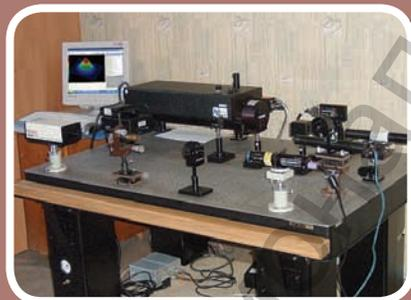
Установка для измерения пространственных характеристик лазерного излучения
