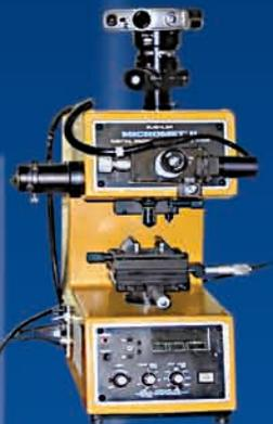
Микротвердомер Micromet II
