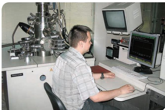
Электронный оже-спектрометр Perkin-Elmer PHI-660
