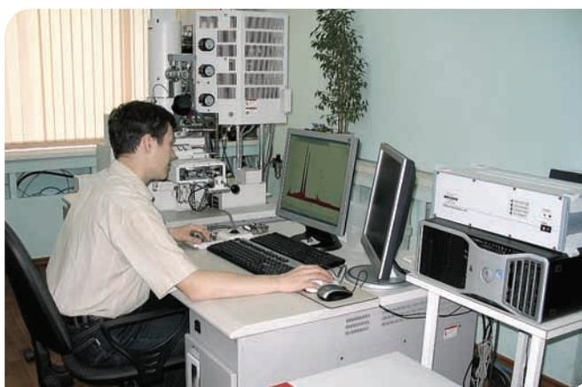
Высокоразрешающий растровый электронный микроскоп HITACHI S-4800 с энергодисперсионным спектрометром Bruker QUANTAX 200
