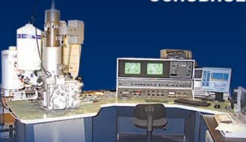
Сканирующий электронный микроскоп CamScan4 с микрорентгеноспектральным анализатором INCA 350
