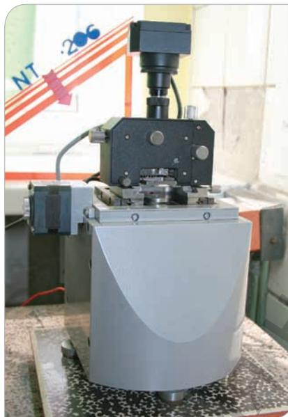
Атомно-силовой микроскоп NT 206
