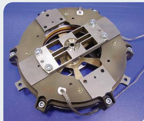
Рис. 3. Оборудование для испытаний материалов в открытом космическом пространстве на международной космической станции: бортовой трибометр и модуль подшипников скольжения
