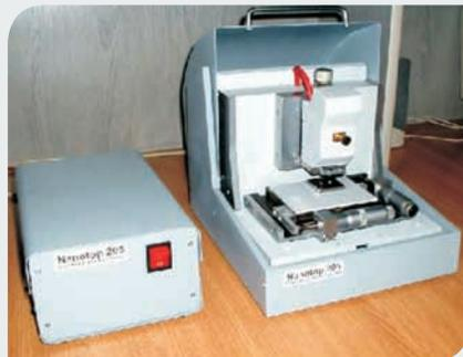
Рис. 1. Атомно-силовой микроскоп модели Nanoscope-205 и прибор ADM-03 для измерения сил межмолекулярного взаимодействия поверхностей фрикционного контакта
