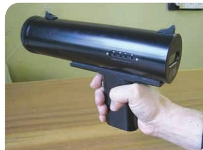
Пирометр оптический цифровой С-109 Л. Назначение: бесконтактное измерение температуры по тепловому (инфракрасному) излучению исследуемого объекта
