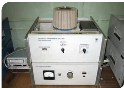
Установка универсальная теплофизическая ИТ-С-400. Назначение: исследование температурной зависимости удельной теплоемкости твердых тел, сыпучих, волокнистых материалов и жидкостей с плотностью не менее 800 кг/м<sup>3</sup>
