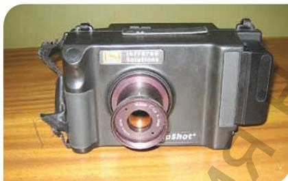
Инфракрасная термографическая камера IR SnapShot 525. Назначение: восстановление температурных полей на поверхности объектов по их собственному инфракрасному излучению
