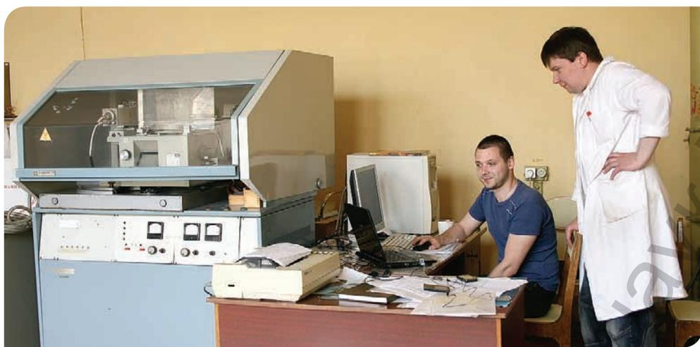
Рентгенофазовый дифрактометр ДРОН 3
