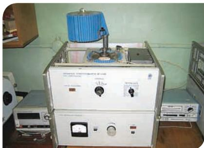
Установка для измерения теплопроводности ИТ-А-400. Назначение: исследование температурной зависимости теплопроводности твердых, механически обрабатываемых материалов в режиме монотонного нагрева
