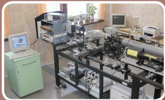
Установка для измерения энергетических характеристик лазерного излучения
