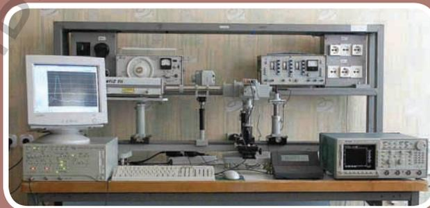
Установка для измерения временных характеристик лазерного излучения
