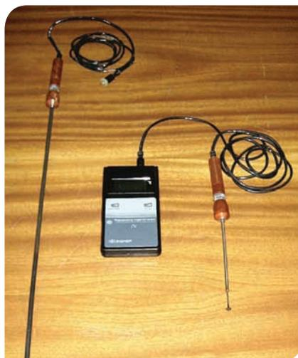
Термометр ТЦМ 9210. Назначение: измерение температуры различных, в том числе агрессивных, сред путем погружных или поверхностных измерений
