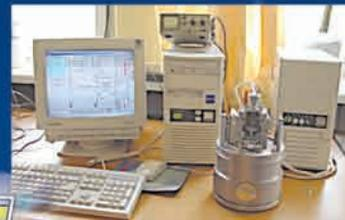
Рентгенофлуоресцентный спектрометр ED 2000 фирмы Oxford Instruments, Англия
