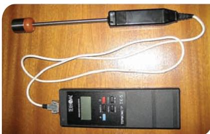
Контактный цифровой термометр ТК-5. Назначение: измерение температуры по величине электрического сигнала зонда (датчика), который контактирует непосредственно с объектом измерения, в том числе определение усредненного значения температуры за определенный промежуток времени
