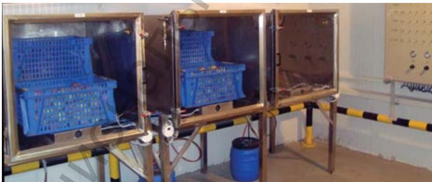
Модельный стенд для отработки режимов газовой хранения
