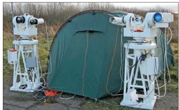
Рис. 4. Многозональная цифровая оптическая экспериментальная аппаратура регистрации изображений и измерения температурных полей ракет-носителей
