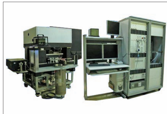
ЭМ-6729, установка автоматического контроля на соответствие проектным данным оригиналов топологий и СБИС
