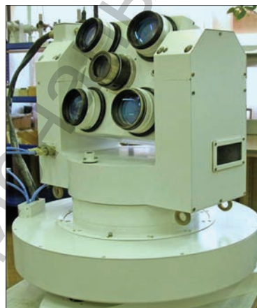
Рис. 2. Опытный образец широкопольной телевизионной регистрирующей станции со специальным программным обеспечением
