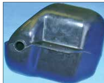
Рис. 2. Сепаратор паров бензина автомобилей ВАЗ, получаемый методом экструзии с раздувом из полиамидного сверхударопрочного материала
