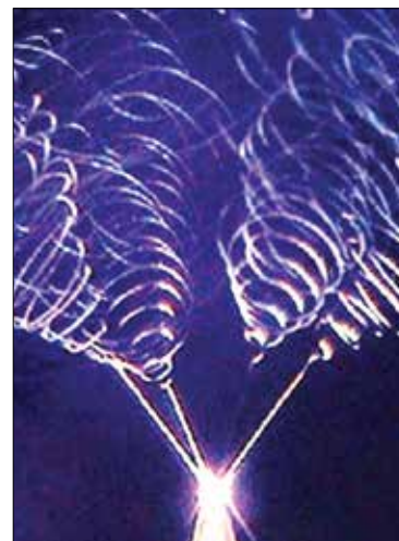
Рис. 2. Внешний вид конуса Тейлора
