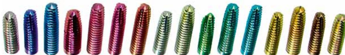
Исследование поверхностных характеристик оксидированных титановых имплантатов показало увеличение их износостойкости в 5–18 раз по сравнению с необработанными изделиями.
