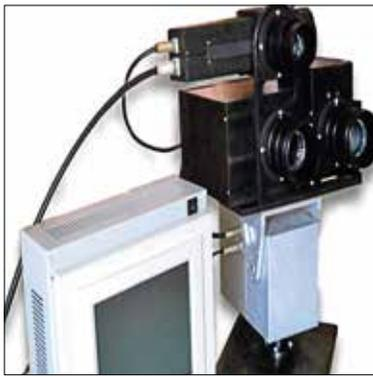
проводить наземные, авиационные и космические измерения спектрально-отражательных характеристик подстилающих поверхностей; получать исходные данные для выполнения полетных калибровок Белорусского космического аппарата и других космических съемочных систем.
