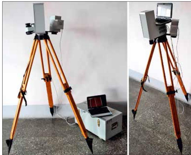
Рис. 8. Приборы ДМС, ПСР-700 и ПСР-1300 АПК «Калибровка» в рабочем положении на треноге
