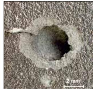
сцепления плазменного покрытия с основой. Проведены баллистические испытания разработанных образцов стойких к ударно-абразивному износу экранов противометеорной защиты.
