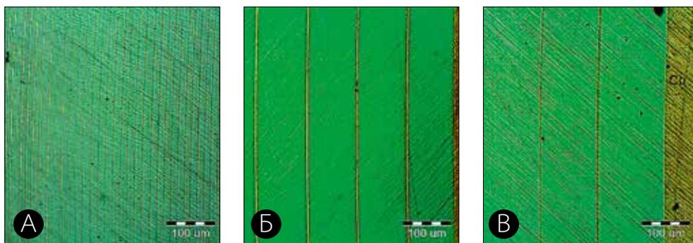
Рис. 1. Оптические изображения шлифов МПЭ системы  $NiFe/Cu$ , содержащих: **А)** 50 слоев  $NiFe$  + 49 слоев  $Cu$ ; **Б)** 8 слоев  $NiFe$  + 7 слоев  $Cu$ ; **В)** 5 слоев  $NiFe$  + 4 слоя  $Cu$
