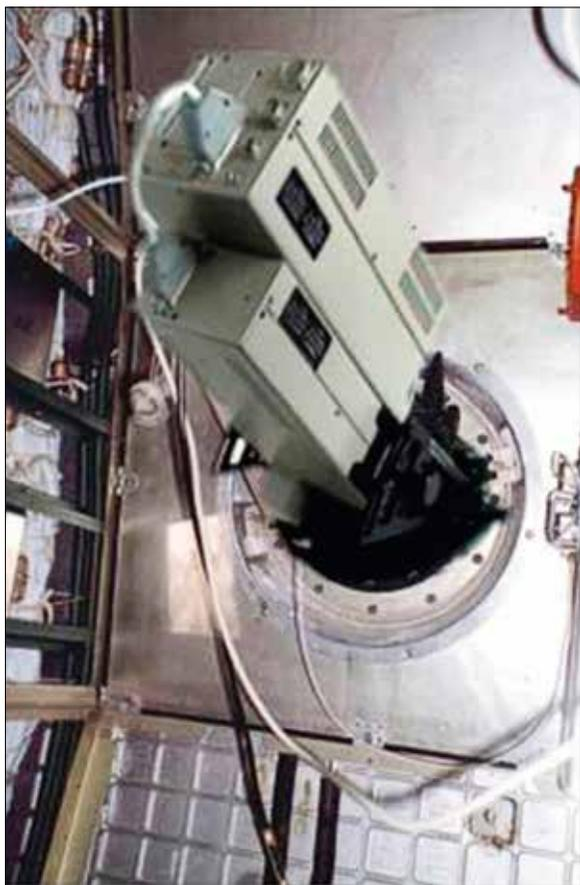
Рис. 1. Бортовая микропроцессорная видео-фотометрическая система ВФС-3М, установленная на иллюминаторе служебного модуля МКС
