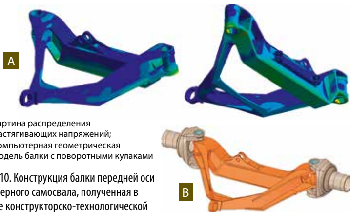
Рис. 9. Результаты топологической оптимизации для конструкции балки передней оси карьерного самосвала
