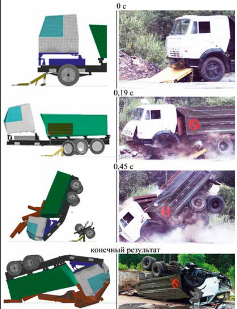
Рис. 7. Сопоставление результатов виртуального и натурального экспериментов по столкновению автомобиля-самосвала с УОКТ
