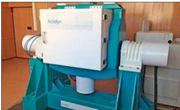
Рис. 2. Двухосевой станд ST2356 с термокамерой производства компании «ACTIDYN SYSTEMES S.A.» (Франция)
