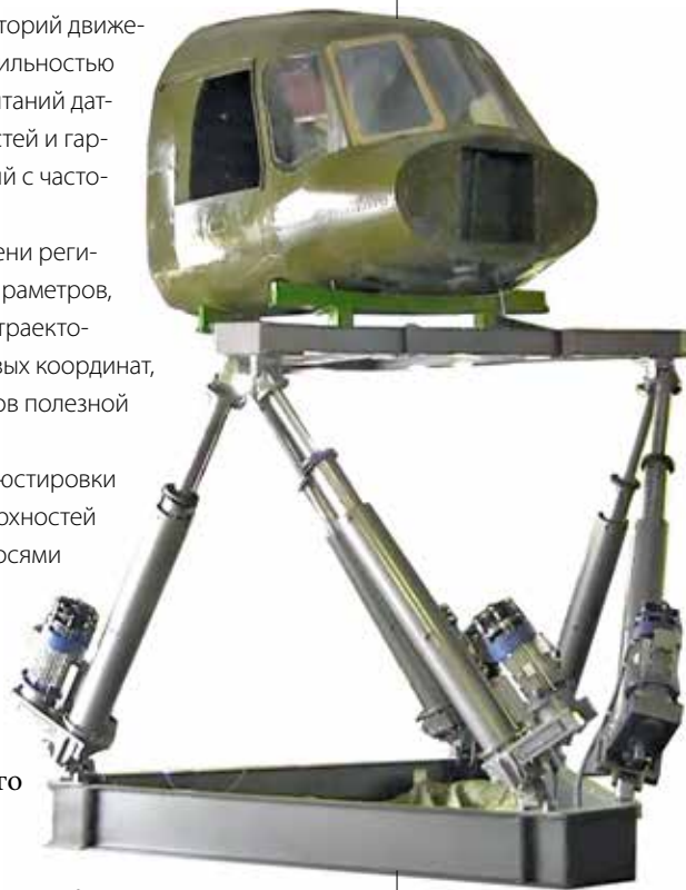
Рис. 3. Электро-механическая платформа Стюарта обеспечения подвижности
