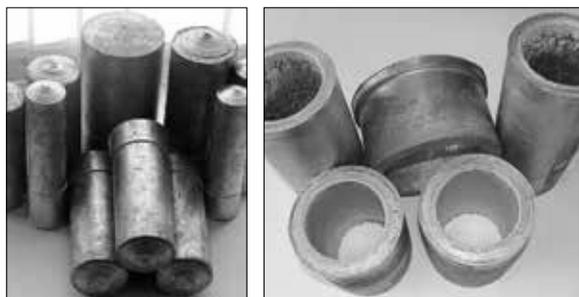
Рис. 7. Сплошные и полые заготовки из антифрикционного СГК
