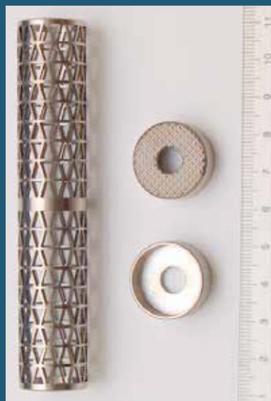
Рис. 4. Сетчатый титановый имплантат с двумя опорными крышками (крышки – вид сверху и снизу)
