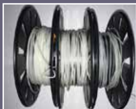
Пруток для 3D-печати из поли-L-лактида с добавками гидроксиапатита (1,0–5,0 мас.%)
