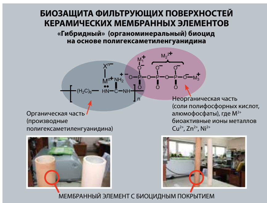
Рис. 1. Органо-минеральные биоциды для защиты фильтрующих поверхностей керамических мембран
