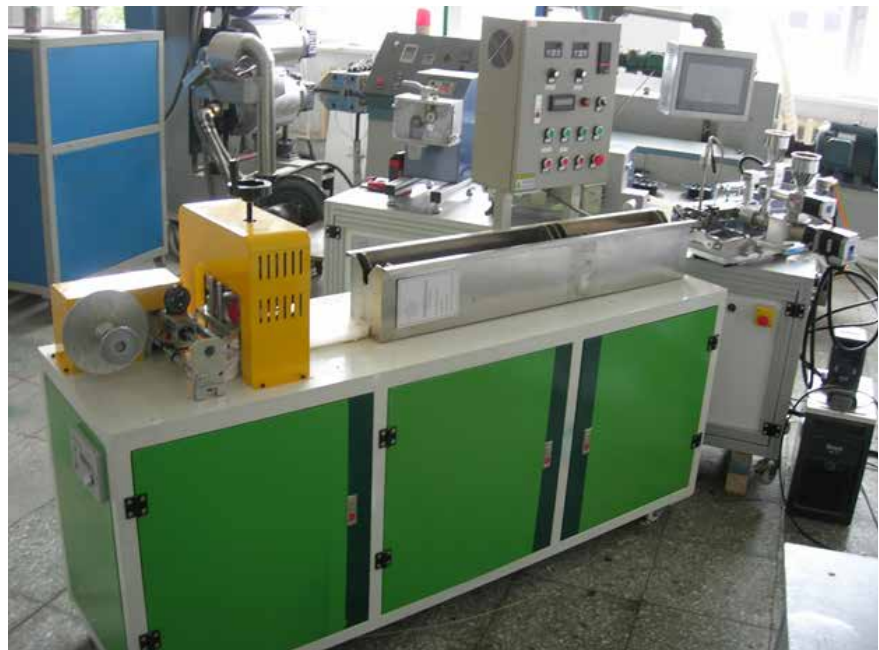
Рис. 4. Лабораторный экструдер ИХНМ НАН Беларуси
