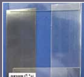
Поли-L-лактидные пленки с добавками гидрохлорида полигексаметиленгуанидина и лигнина
