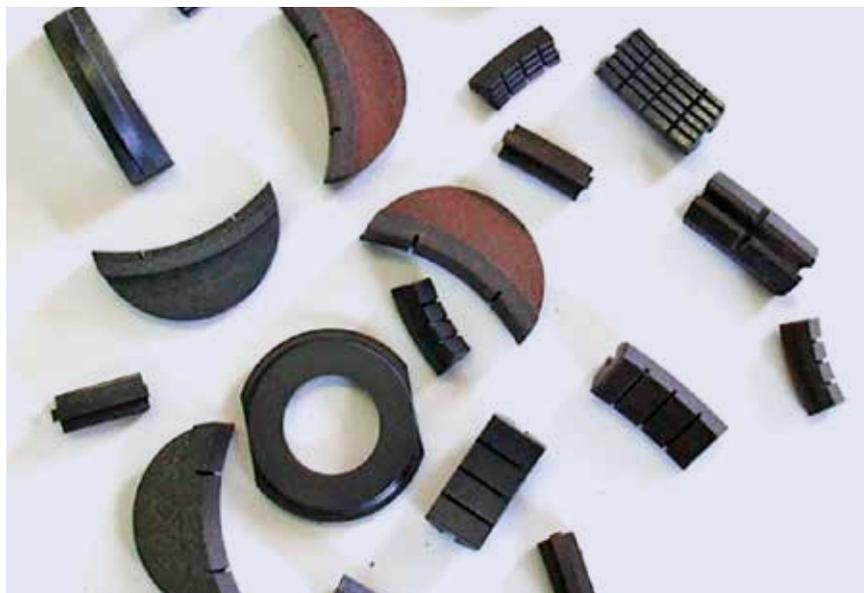
Изделия из разработанных композиционных материалов, предназначенные для узлов стационарного трения канатных машин
