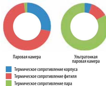
Рис. 12. Соотношения термических сопротивлений для частей паровой камеры и ультратонкой паровой камеры
