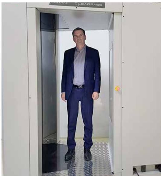
Рис. 3. Интегрированный в камеру рентгенологического контроля бактерицидный шлюз
