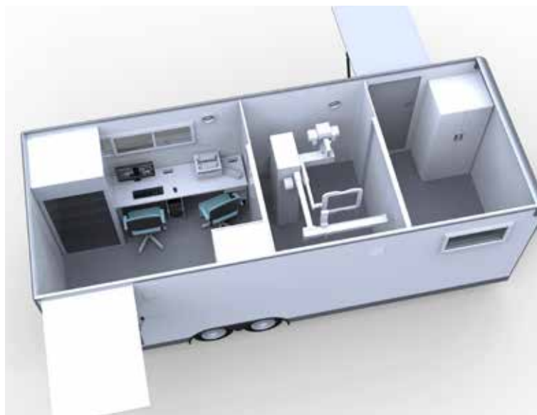
Рис. 4. Мобильный вариант COVID-лаборатории с дезинфицирующими шлюзами на входе и выходе
