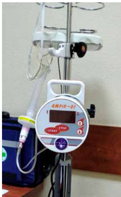
Рис. 6. Мобильный вариант устройства для подогрева КГС, совмещенный с баллоном дыхательного ингалятора
